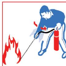
Esparza con la boquilla o la manguera de un lado a otro hasta que el fuego se haya extinguido. Continuar con la descarga del agente hasta que el extintor está vacío. Añada a la zona en caso de re-ignición.
